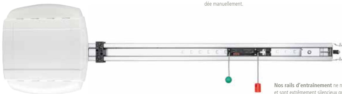
Déverrouillage d'urgence En cas de panne de courant, il est possible d'ouvrir et de refermer la porte en toute fiabilité via le déverrouillage d'urgence. Il suffit de tirer sur le déverrouillage pour déconnecter la porte de l'automatisme. La porte peut être commandée manuellement.
